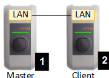
Fig. 2-3: Collegamento diretto tra master e client
